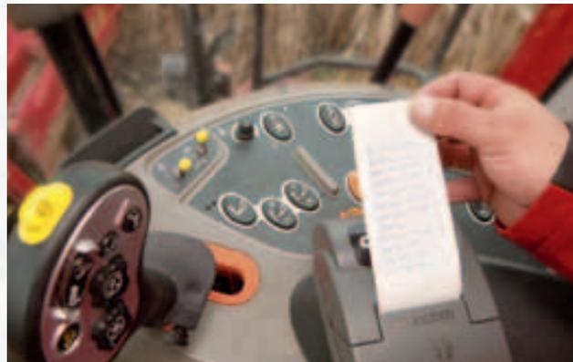
Für Lohnunternehmer ist ideal, dass auf Maschinen, die für die Ertragserfassung ausgerüstet sind, mit einem Drucker die Daten zu Leistung und Fläche für den Kunden unmittelbar zum Arbeitsende ausgedruckt und ausgehändigt werden können.
